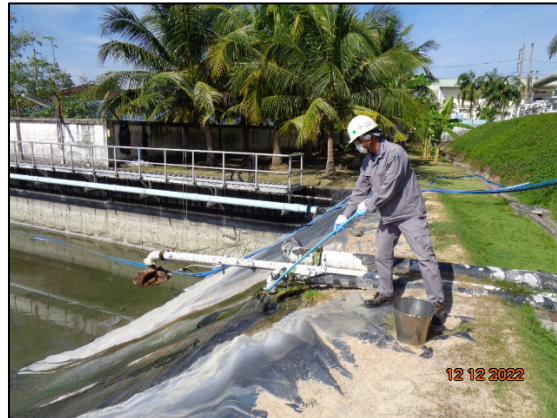
รูปที่ 3.10 การเก็บตัวอย่างคุณภาพน้ำทิ้ง บริเวณ น้ำทิ้งก่อนเข้าบ่อรับน้ำทิ้ง Wastewater Pond
